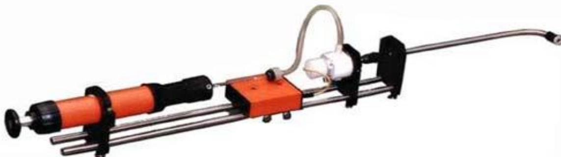
Рисунок 4 – Газоопределитель ГХК
