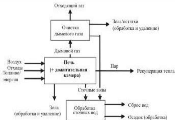
Рисунок 1 – Схема сжигания отходов
