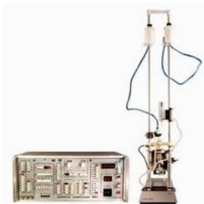
Рисунок 6 - Полярограф
