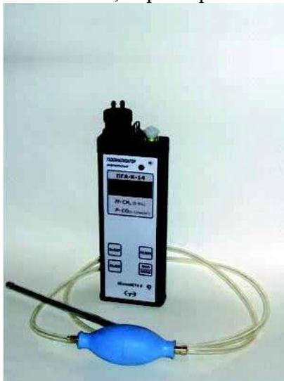
Рисунок 2 – Газоанализатор инфракрасный ПГА
