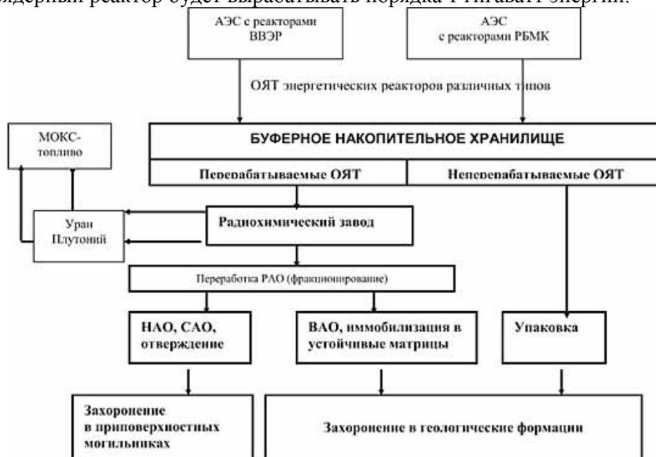
Рисунок 3 – Схема утилизации РАО и ОЯТ в современное время.
