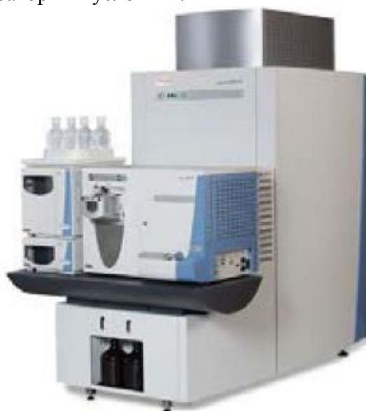
Рисунок 3. Новый масс-спектрометр для протеомики Finnigan LTQ FT
