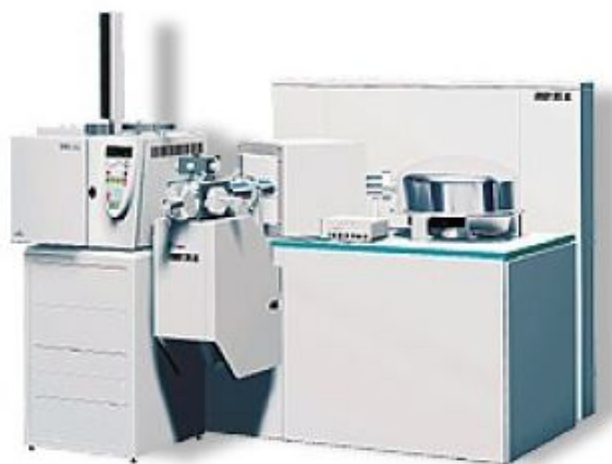
Рисунок 2. Хромато-масс-спектрометр FIN NIG AN MAT 95XP (Trap)
