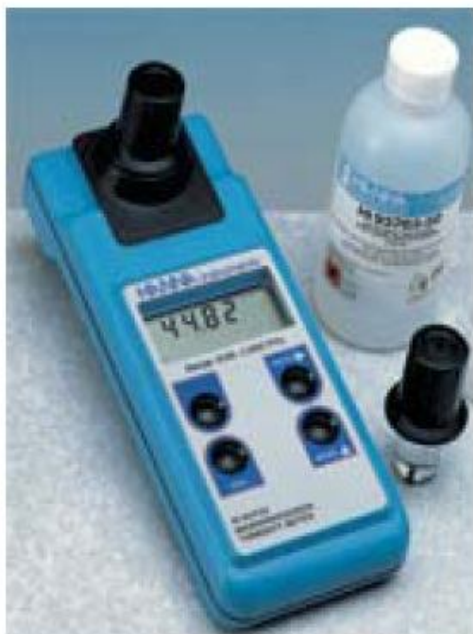
Рисунок 5. Турбидиметр. Измеритель мутности HI-93703 Hanna instruments
