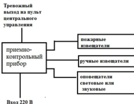
Рисунок 1 – Схема пожарной сигнализации
