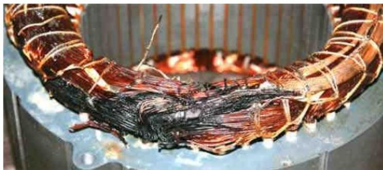
Рисунок 4 - Сгоревшая обмотка мотор-генератора MG2.
