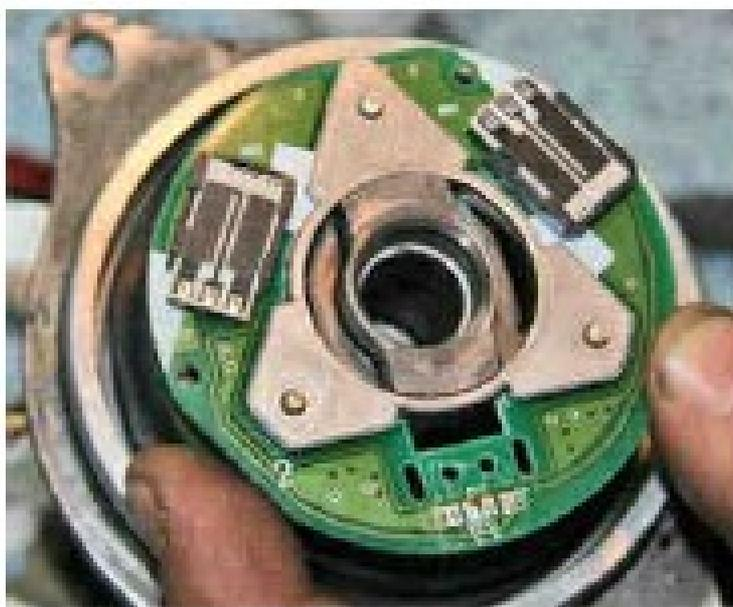
Рисунок 1 - Датчик крутящего момента рулевого колеса
