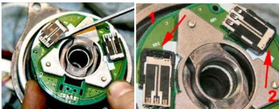
Рисунок 3 - Torque Sensor в разобранном виде
