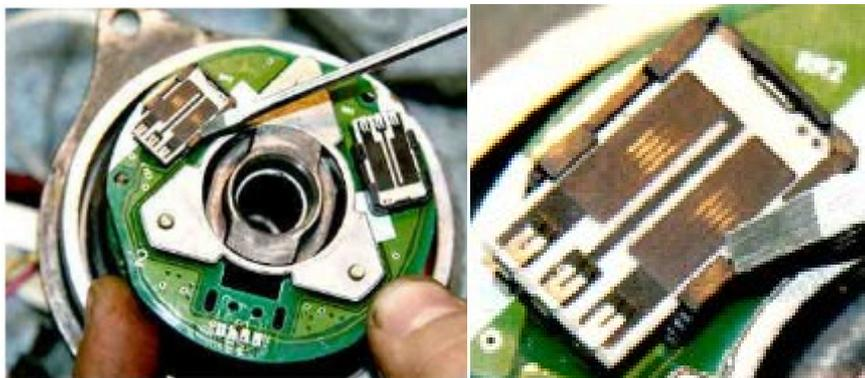
Рисунок 4 - Истончение контактного слоя резистивной дорожки
