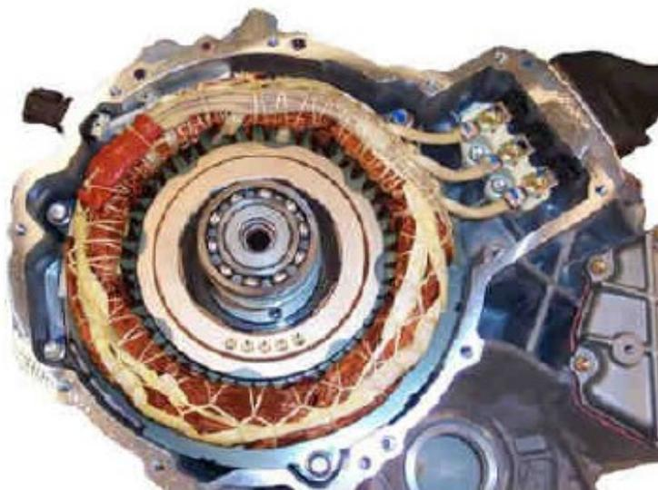
Рисунок 3 - Мотор-генератор MG2
