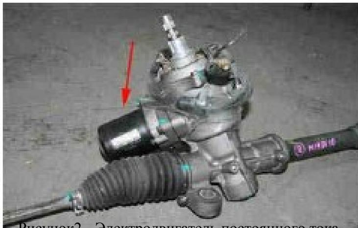
Рисунок2 - Электродвигатель постоянного тока
