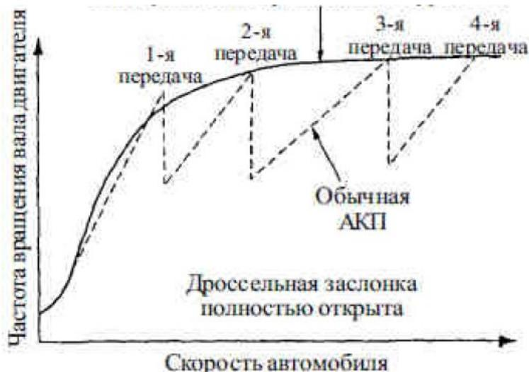
Рисунок 1- Скоростная характеристика трансмиссии
