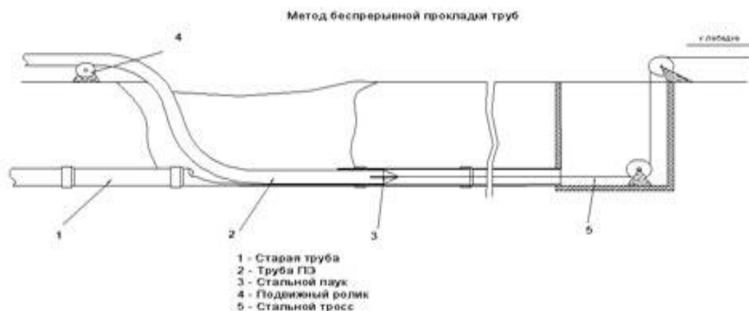
Рисунок 1 - Метод непрерывной прокладки
