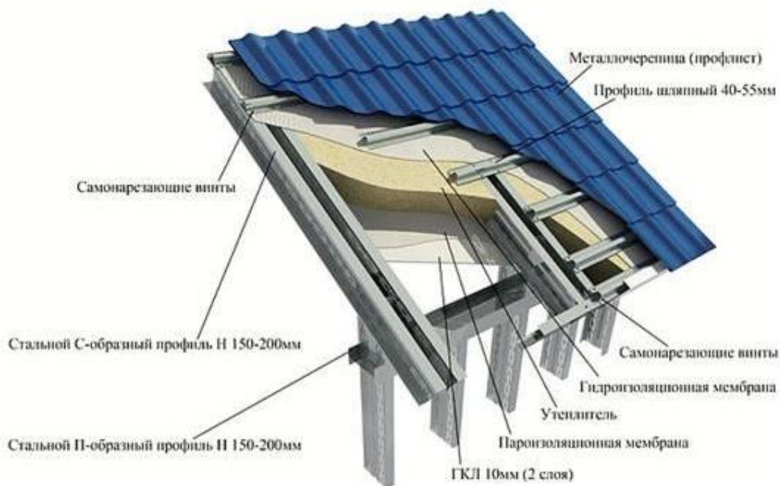
Рисунок 1 – Устройство конструкции мансарды из ЛСТК
