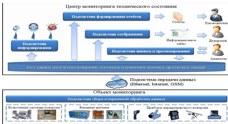
Рисунок 1 - Архитектура автоматизированной системы мониторинга
