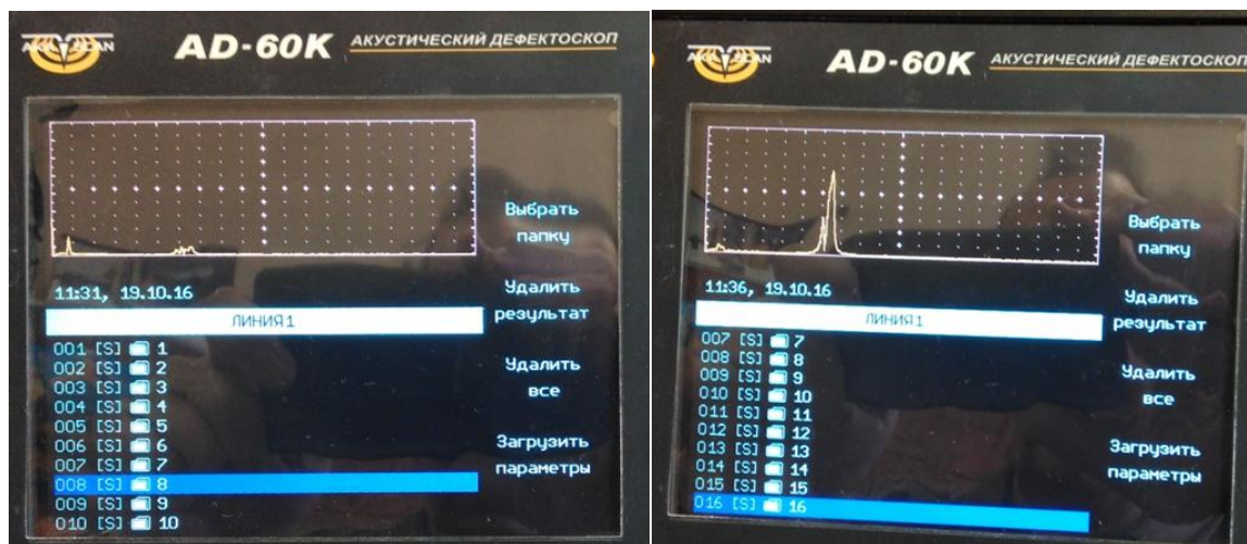
Рисунок 3 – универсальный акустический и импедансный дефектоскоп АД-60К: а – в отсутствии дефектов в структуре КМ; б – при наличии дефекта типа расслоение
