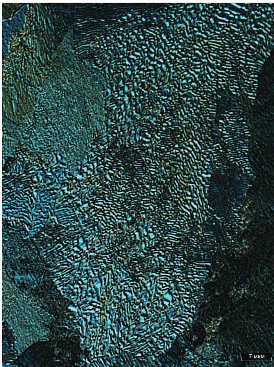
Рисунок 1. Микроструктура перлита с фрагментированными цементитными пластинами x1000 [The microstructure of pearlite with fragmented plates of cementite x1000].
