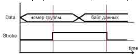
Рисунок 2. Временная диаграмма операции пересылки управляющего слова в ВИУ.
