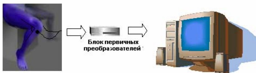
Рис.2 Структурная схема комплекса
