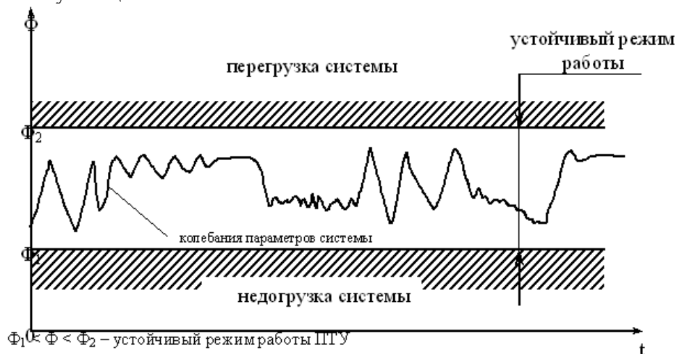
Рисунок 2 - Определение устойчивости ПТУ через целевую функцию \Phi
