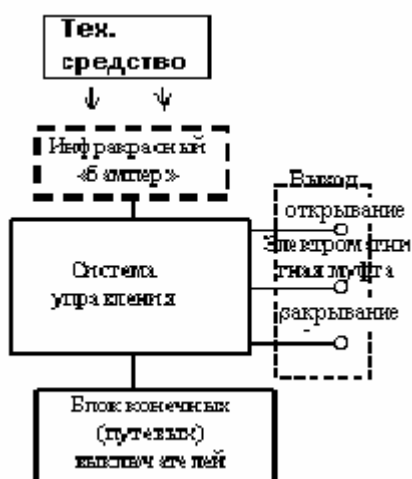
Рис.2 Схема системы управления распашными автоматическими воротами складского помещения (одного элемента общей системы ATSS)
