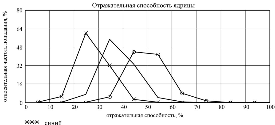
Рисунок 1 – Гистограмма распределения яркости ядрицы
