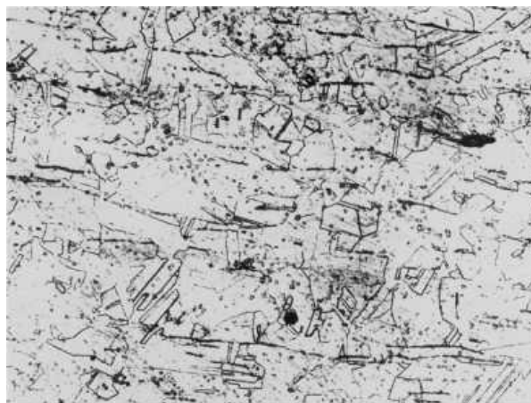
Рисунок 1 – Микроструктура проката стали 12Х18Н10Т (×500)
